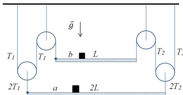
Рассмотрим нижнюю доску после размещения грузов. Запишем проекцию баланса сил на вертикальную ось и баланс моментов сил относительно точки закрепления левой нити (см. Рис)
