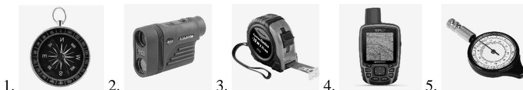
**Ответ: 1. Компас; 2. Лазерный дальномер/дальномер; 3. Рулетка; 4. Навигатор; 5. Курвиметр.**
