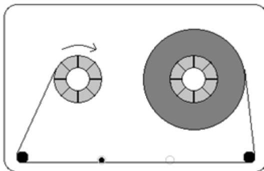
В режиме перемотки (см. рисунок) лента двигалась только за счет двигателя, задававшего частоту оборотов ведущей катушки. Лента перематывалась с ведомой катушки на ведущую.
